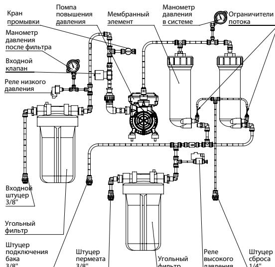
Рисунок 5. Схема системы RObust 3000
